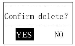
Press key 【 】 or 【 ➤ 】 to move the cursor to 【YES】 and press key 【 ENTER 】 to confirm deleting operation.
